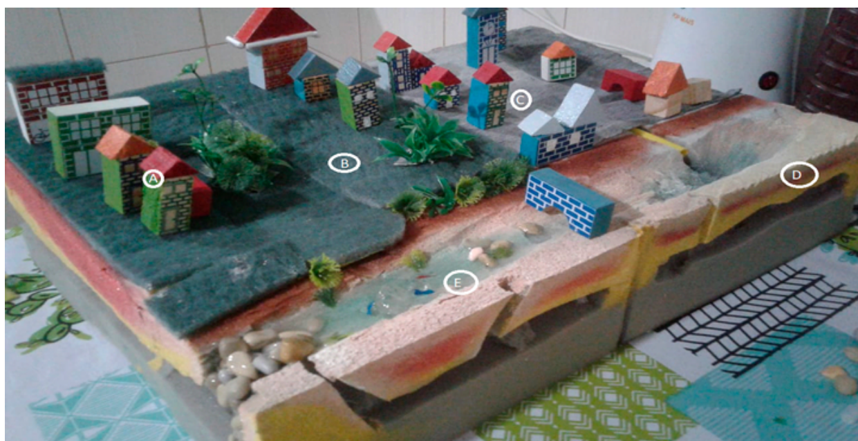
Figura 1 – Disposição de materiais da maquete: a) bloco de madeira (5 centímetros); b) superfície permeável com esponja de cozinha (30 × 25 centímetros); c) cobertura impermeável em tecido de algodão (30 × 25 centímetros); d) espuma de poliuretano (50 × 35 × 12 centímetros); e) rio de resina epóxi (5 × 40 centímetros)
