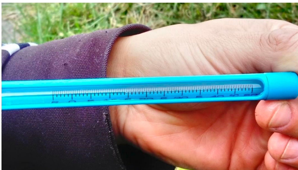
Figura 3 – Medição da temperatura da água coletada no rio
