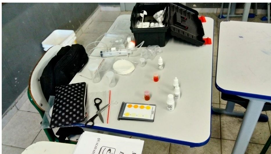
Figura 7 – Kit utilizado para fazer a análise de água na escola
