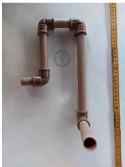
Figura 2 – Construção do sifão U
