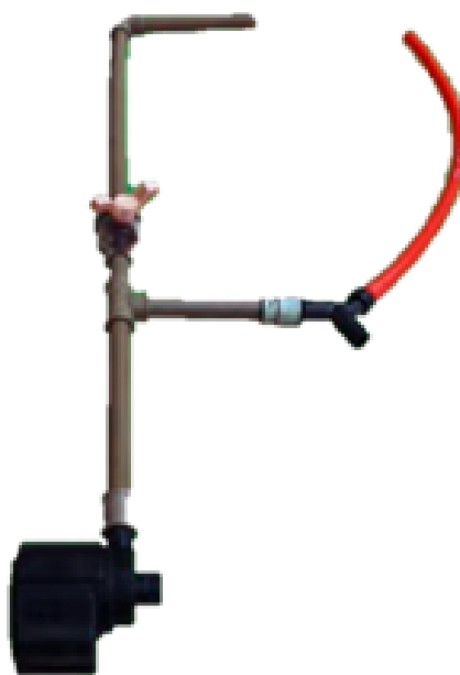
Figura 5 – Conexões da bomba submersa para a cama de cultivo
