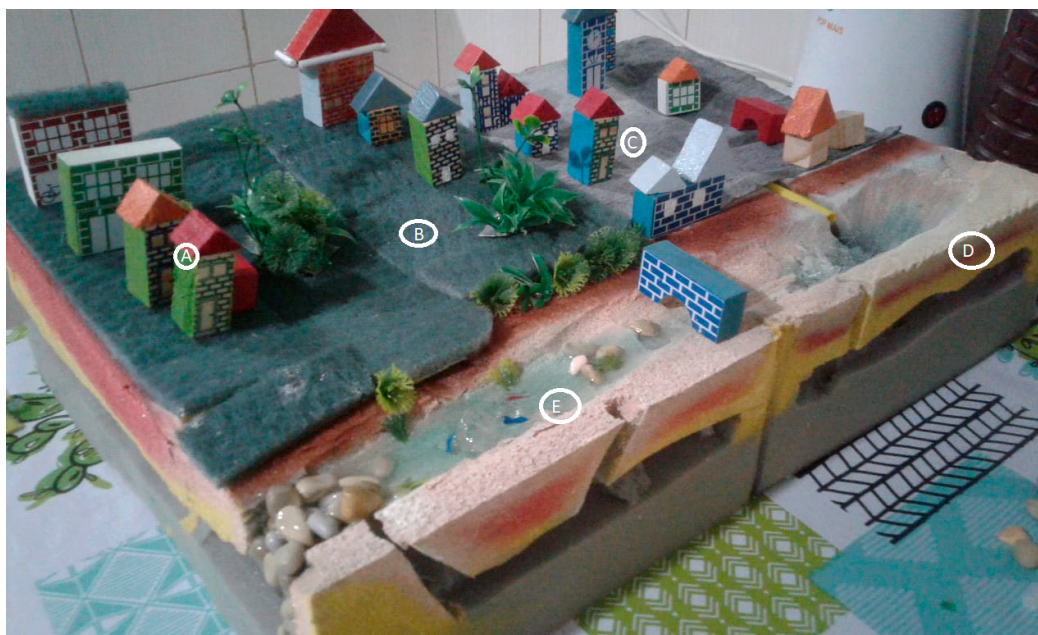
Figura 4. Disposição de materiais da maquete: (a) bloco de madeira (5cm), (b) superfície permeável com esponja de cozinha (30x25cm), (c) cobertura impermeável em Tecido de algodão (30x25cm), (d) espuma de poliuretano (50x35x12 cm), (e) rio de resina epóxi (5x40cm).
